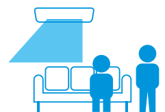
Flux d'air dirigé à l'écart des occupants
